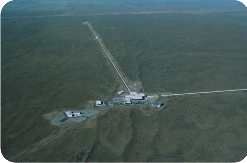
LIGO está formado por dos observatorios: uno en Luisiana y otro en Washington (arriba). Cada observatorio tiene dos «brazos» largos, y cada uno de ellos tiene más de 2 millas (4 kilómetros) de largo. Fuente: Caltech/MIT/LIGO Lab
